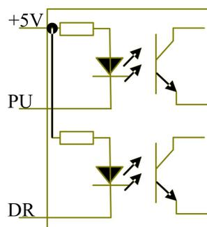
图 6.1-2 三输入，驱动器输入信号共阳
