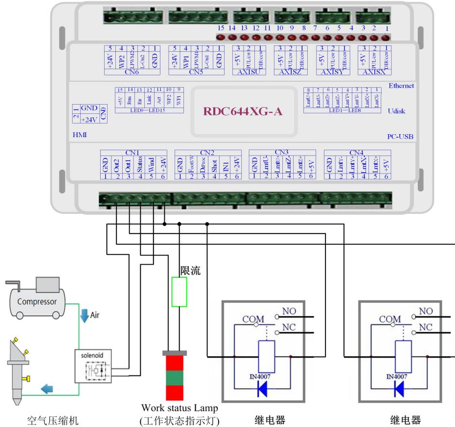
图 7.2-1 输出口接法示例
